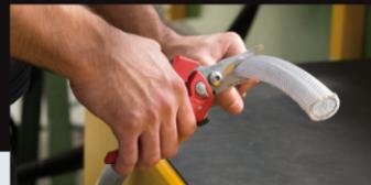
Grande puissance et variété de coupe : permet la coupe de plastique, feillard, tôle fine, nylon, cuir, caoutchouc...
